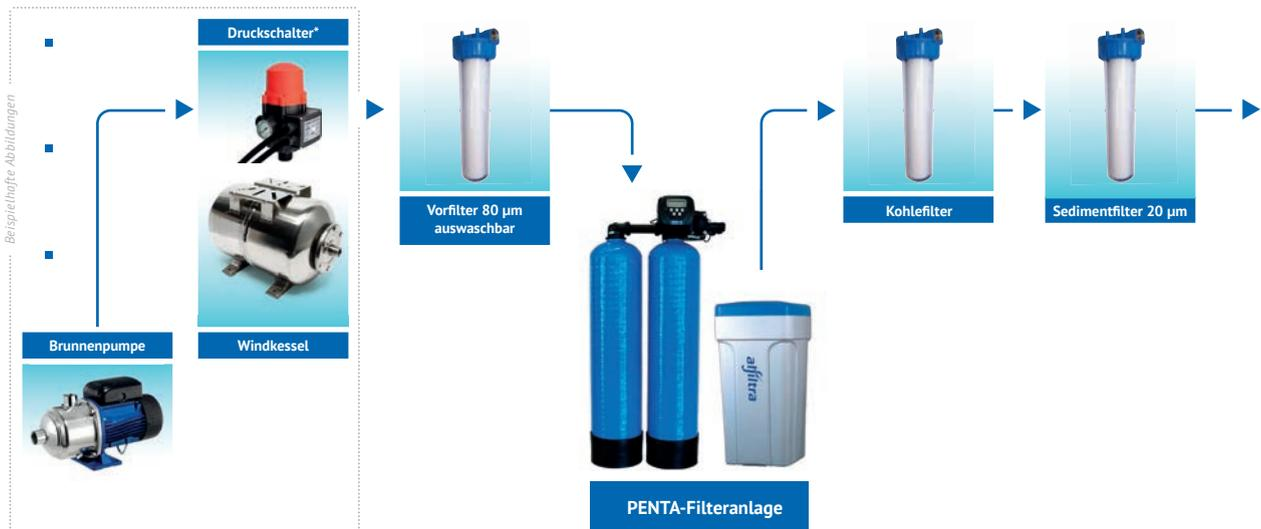
Der Druckschalter muss vor der Penta-Anlage installiert sein. Ist dies nicht möglich, muss ein zweiter Druckschalter mit kleinem Windkessel montiert werden. Der elektrische Anschluss erfolgt parallel.
