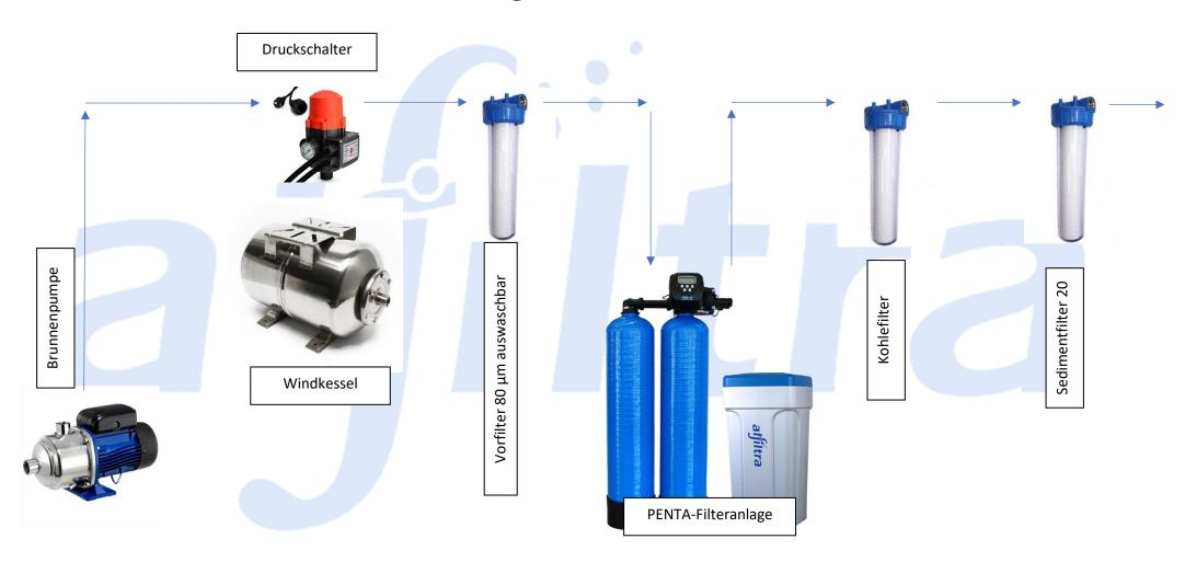
Der Druckschalter muss vor der Penta-Anlage installiert sein. Ist dies nicht möglich, muss ein zweiter Druckschalter mit kleinem Windkessel montiert werden Der elektrische Anschluss erfolgt parallel.
